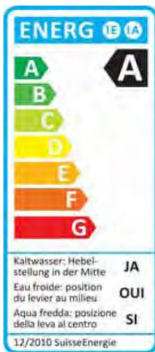
**Il existe une étiquette Energie spéciale pour les robinetteries fournissant de l'eau qui est froide et non tiède, lorsque le levier est au milieu. Ce dernier ne peut être déplacé que vers la gauche et vers le haut. La photo montre comme exemple le mitigeur monolevier AVA de KWC.**
